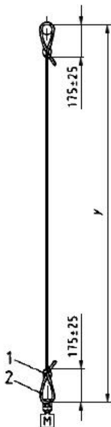
а) Образец для динамических испытаний (см. 5.9)
